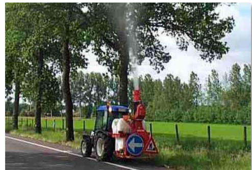
Figuur 14: Sproeien van biociden met een boomnevelspuit
